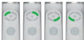
4 segmenten knipperen groen: zelftest en kalibratie
